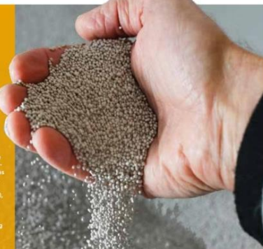
Struvitanlægget har potentiale til at udnytte op til 30 % af den fosfor, der kommer ind på renseanlægget.
